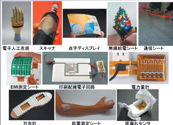
図2 有機トランジスタを用いた大面積・フレキシブルエレクトロニクス
