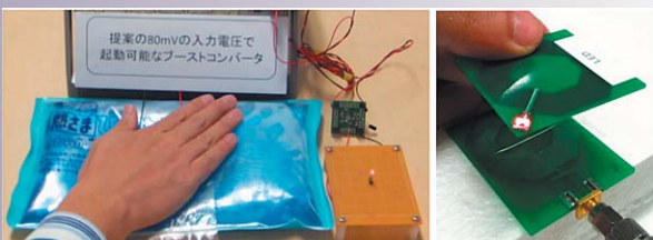
図4 温度差発電(左)と無線給電(右)でLEDを点灯した実証実験
