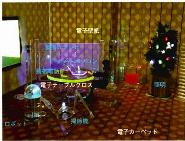
図8 電力伝送シートをおもちゃの家の内側に貼り付けて電力伝送実験を行った。2Wの電力を伝送し、15個の発光ダイオードを点灯させた。このシートは軽量・薄型であるため、電子壁紙や電子カーペットのように壁や床に貼り付けることが容易であり、コンセントやケーブルのない新しいライフスタイルを実現していくと期待される。
