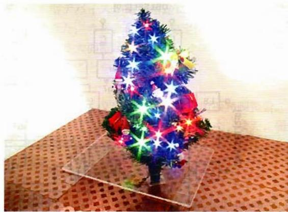
図5 電力伝送実験のデモ写真。21 個の発光ダイオードで飾られたクリスマスツリーを電力伝送シート上に置き、2 W の電力を無接点で伝送し、点灯させた。
